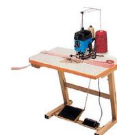
Fußregler mit Kabel und Stecker zur stufenlosen Geschwindigkeitsregelung
