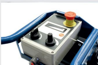
Display mit Leistungsanzeige und Betriebsstundenzähler
