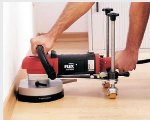
Beim Schleifen von Treppenstufen können die Stellräder zur Führung auf der unteren Stufe bis zu einer Höhe von 22 cm eingestellt werden.
